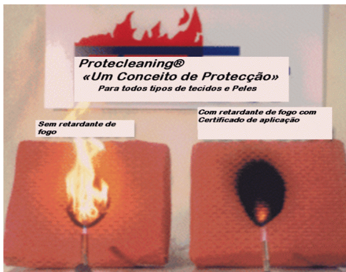
Figura 3. Ação do fogo em estofamento sem retardante de fogo e o outro com a aplicação, para classes de fogo 1 e 2. (PROTECLEANING, 2009)
