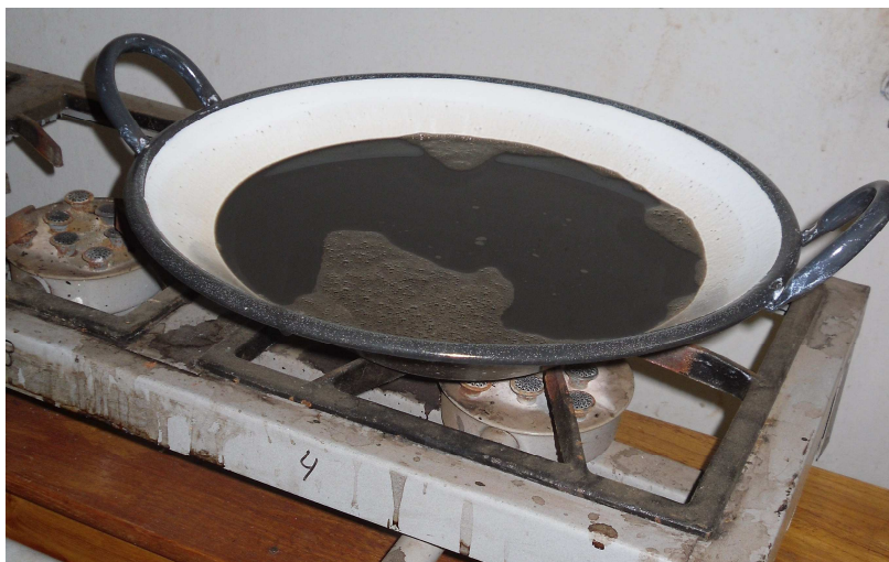
Figura 1 - Concentração do resíduo efluente mediante aquecimento para evaporação d'água.
