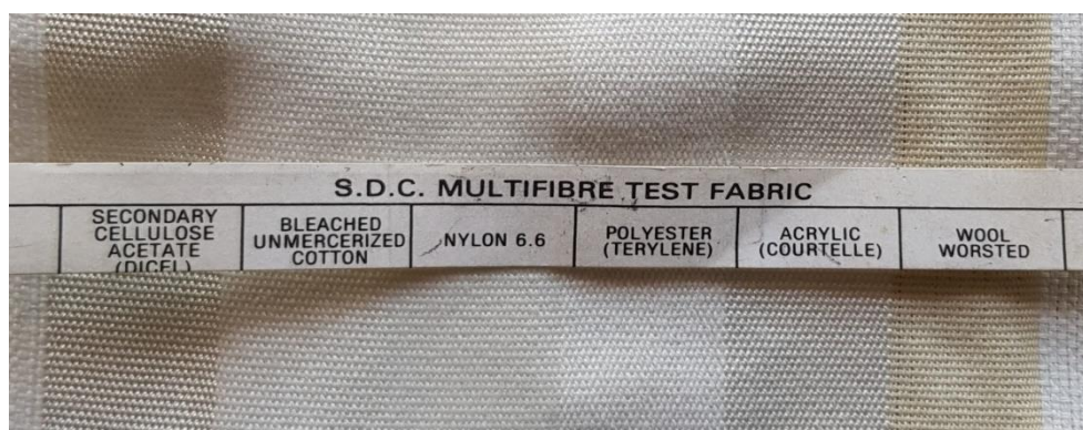
Figura 3.5: Tecido testemunho multifibra usado para avaliar a solidez do tingimento nos tecidos de lã.
