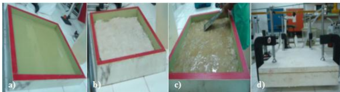
Figura 4 – Fabricação do compósito: a) Molde para preparação do compósito com resina de poliéster, b) Manta de PALF, c) Molde com o compósito, d) Molde com o compósito e fixado com grampos.
